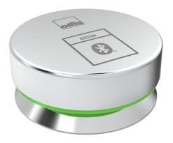
Oras elektronisk avstengningsventil for oppvask – eller vaskemaskin. Produktet består av en trådløs Smart trykk-knapp, en kontrollenhet og en elektronisk ventil. Ventilen er åpen i 4 timer. Det er mulig å forlenge åpningstiden til 12 timer ved å holde knappen inne i lenger enn 5 sekunder. Batteridrift (3 V).
