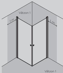
Skruvinfästningar i våtzon 1 ska göras i betong eller annan massiv konstruktion (a), träreglar, träkortlingar (b) eller i konstruktion som är provad och godkänd för infästning, till exempel skivkonstruktion (c). Se exempel på godkända konstruktioner på säkervatten.se.
