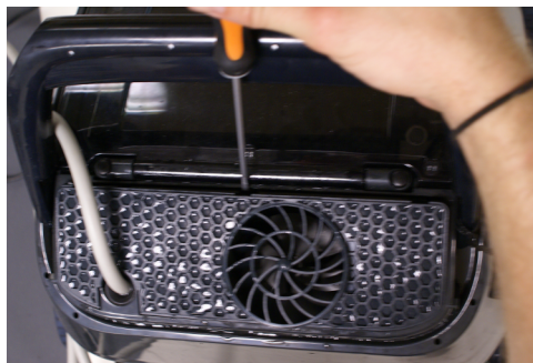
8.1. Bruk en flatskrutrekker for å fjerne beskyttelsesgitteret.
