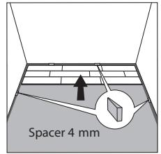
**SISTE RADEN** skal være mer enn 5 cm bred. Mål bredden på den manglende raden. Husk 4 mm avstand til vegg. Kapp deretter vekk (på langs) den uønskete delen med aluminiumlist. Legg det utsagde gulvbordet.
