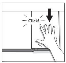
Når du har lagt tre fulle rader skyver du gulvflaten inn mot vegg til riktig leggeavstand, 4 mm. Bruk avstandsklosser! Dersom veggene er skjev eller ujevn, må veggens form overføres til gulvbordene. Ta opp igjen den første raden, sag til ujevnheten og legg tilbake gulvbordene ved å skyve dem i vinkel under gulvbordene som allerede er lagt.
