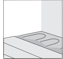
**Elektrisk gulvvarme:** Isolasjonsplatene som benyttes må ha en trykkfasthet (CS) på min. 300 kPa (30 tonn/m<sup>2</sup>).
