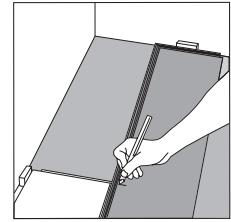
**START AV RAD 2** Gulvbordene må legges forbandt med en forskyvning på min. 1/3 gulvbord mellom endeskjøtene. Dersom avkapp fra foregående rad er for kort begynner du med et nytt gulvbord som kuttes i to.
