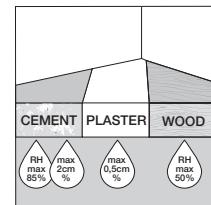
Undergulv i betong/lettbetong (inkl. avrettingsmasse) eller keramiske fliser (uansett om de har innebygd fuktsperre eller det er installert belegg oppå), belegg og generelt undergulv med gulvarme krever fuktisolering. Bruk en aldersbestandig PE-folie med en tykkelse på min. 0,20 mm, som legges med minst 20 cm overlapp i skjøtene, teipes og bøyes opp langs veggene. Plastfolien renskjæres etter at gulvet er ferdig lagt.
