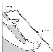
**START** i venstre hjørne. Plasser gulvbordet med aluminiumlisten vendt mot rommet og til høyre. Legg mot høyre. Lag en avstand mellom kortsidens og veggen på 4 mm.
