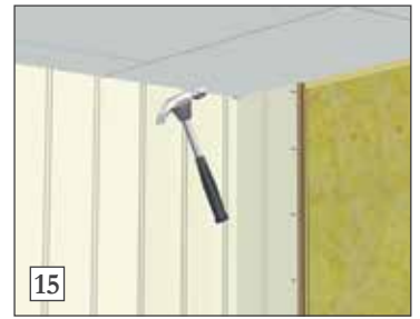
15) Platen spikres så i spikerleppen. Inne i hjørnet spikres platen synlig med dykkstift (håndspikring). Bunn og topp kan spikres på vanlig måte. Man bruker flikkmalingen (i org.fargen) til å male hodene på de synlige dykkstiftene. Bruk kosten som sitter i korken på flikkmalingsflasken (se bildet under).
