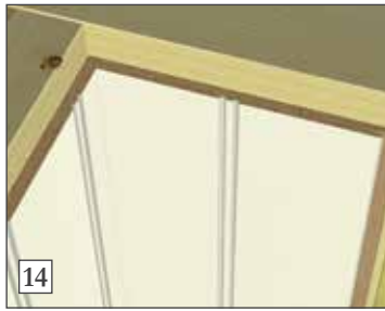
14) Pass på at platen bankes helt inn.
