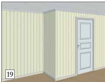
19) Dette gir et perfekt, utvendig hjørne. Den utvendige hjørnelisten kan også limes på.
