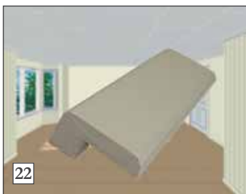
22) Vi kan tilby glatt kombigerikt (foring/gerikt) til bruk rundt vinduer og dører, der det monteres et eks-tra platelag direkte på eksisterende plater/panel under oppussing.
