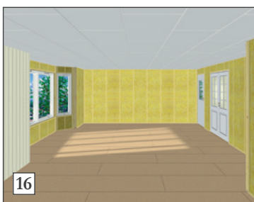
16) Resten av platene monteres på samme måten.
